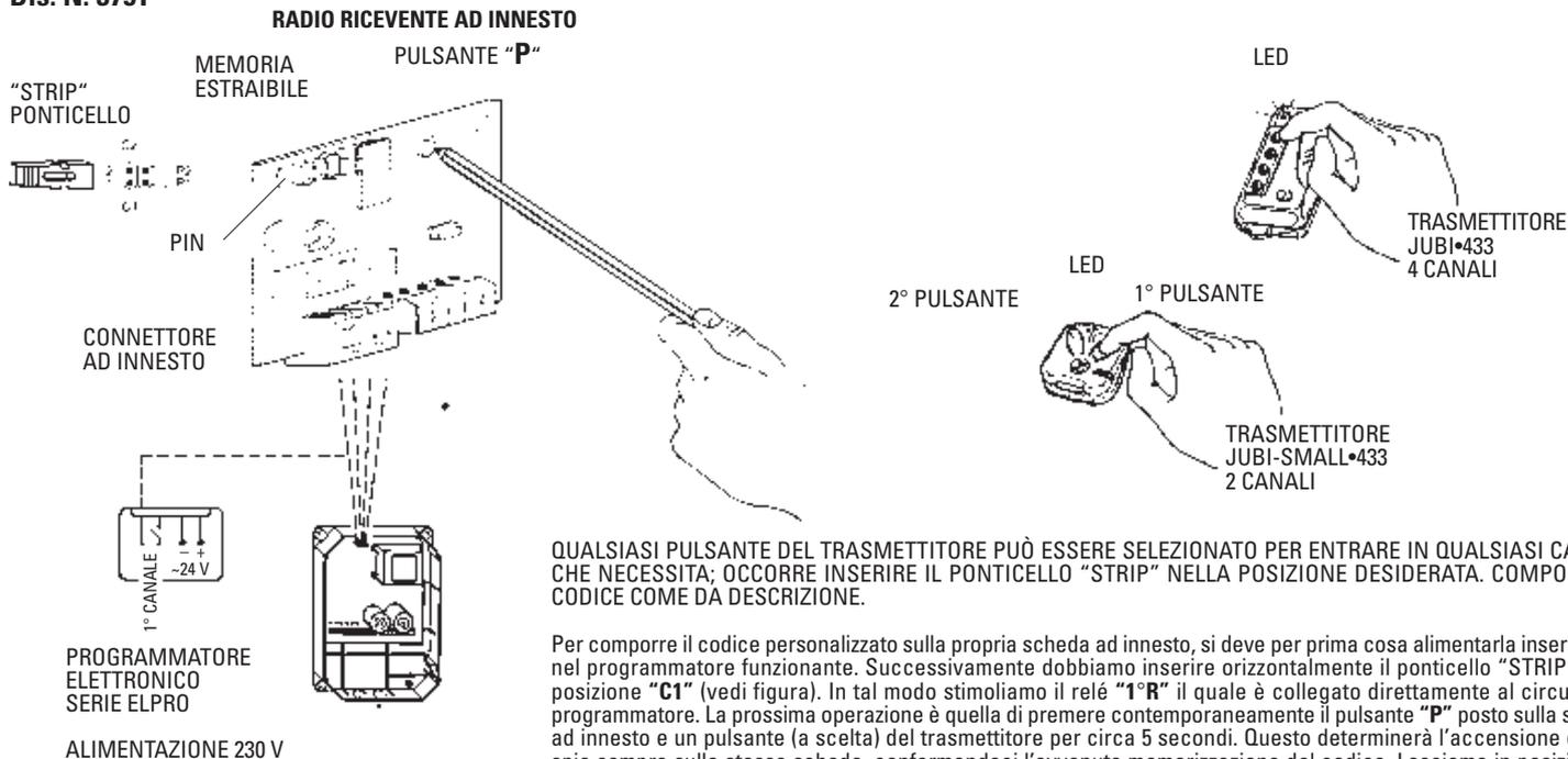
QUALSIASI PULSANTE DEL TRASMETTITORE PUÒ ESSERE SELEZIONATO PER ENTRARE IN QUALSIASI CANALE CHE NECESSITA; OCCORRE INSERIRE IL PONTICELLO "STRIP" NELLA POSIZIONE DESIDERATA. COMPORRE IL CODICE COME DA DESCRIZIONE.
