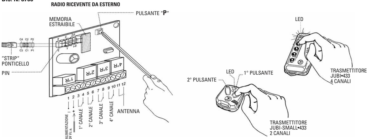
QUALSIASI PULSANTE DEL TRASMETTITORE PUÒ ESSERE SELEZIONATO PER ENTRARE IN QUALSIASI CANALE CHE NECESSITA; OCCORRE INSERIRE IL PONTICELLO "STRIP" NELLA POSIZIONE DESIDERATA. COMPORRE IL CODICE COME DA DESCRIZIONE.
